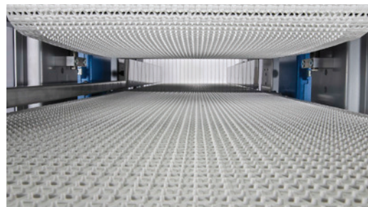
Instelbare bovenband voor de invoer van o.a. ronde broden.
