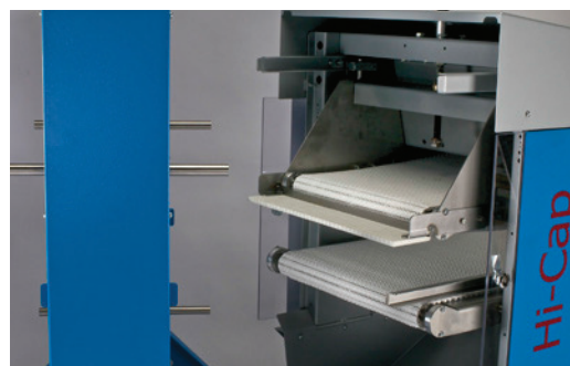
Door een doordacht en modulair ontwerp kan de Hi-Cap makkelijk geopend worden voor onderhoud- en schoonmaakwerkzaamheden.
