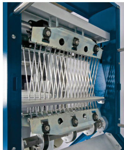
Het unieke en gepatenteerde Cross-Slice Systeem met schuin gepositioneerde messen die tot drie keer langer meegaan.
