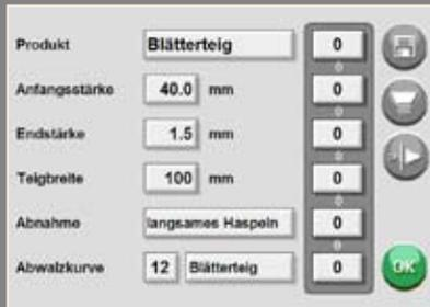
So einfach legen Sie ein Abwalzprogramm für ein bestimmtes Produkt an: Mit einer vollwertigen Tastatur erfassen Sie am Bildschirm den Namen des Produkts, geben Anfangs- und Endstärke und die gewünschte Teigbreite ein. Dann legen Sie noch fest, auf welche Weise das Teigband am Ende abgenommen werden soll (z.B. „langames Haspeln“) und zum Schluss wählen Sie aus den vorhandenen Abwalzkurven die passende aus. Fertig!
