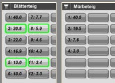
In der Detailansicht zu den einzelnen Abwalzkurven erkennen Sie nicht nur die Anzahl und Abfolge der Abwalzschritte, sondern an der leuchtend grünen Hinterlegung auch gleich, bei welchem Durchgang der Mehler zugeschaltet ist.
