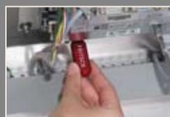
Ein Datenbackup zu Sicherungszwecken ist über die stets vorhandene USB-Schnittstelle jederzeit ganz einfach möglich.
