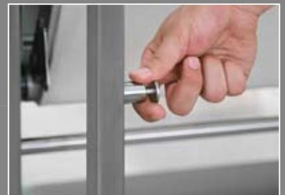
Platz sparend: Bei vielen Modellen lassen sich die Tische hochklappen, wenn die Maschine einmal nicht gebraucht wird. Einfach entriegeln und herunterklappen – schon ist der Tisch wieder einsatzbereit.
