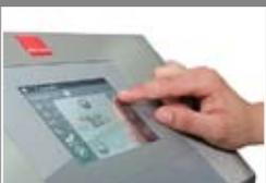
Bessere Sicht, bessere Bedienung: Das Display mit seinen großen, gut bedienbaren Tasten ist ergonomisch vernünftig zum Bediener hin geneigt.
