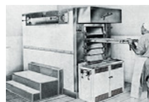
Four à recyclage d'air chaud « Cyclair »
