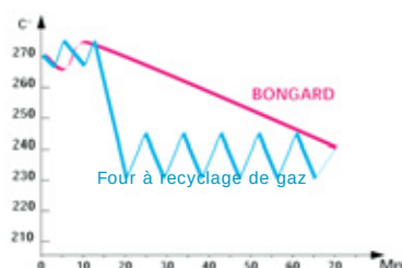
A. Principe de cuisson en chaleur tombante
